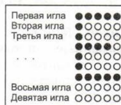
Рис. 1.15. Технология печати матричного принтера
