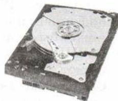
Рис. 1.21. Жесткий диск со снятой крышкой корпуса
