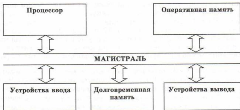
Рис. 1.1. Функциональная схема компьютера
